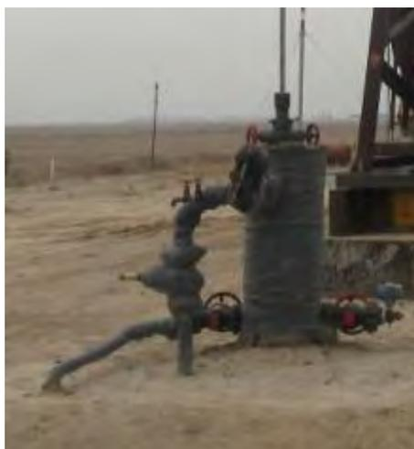
图 3-2 套管气回收装置
