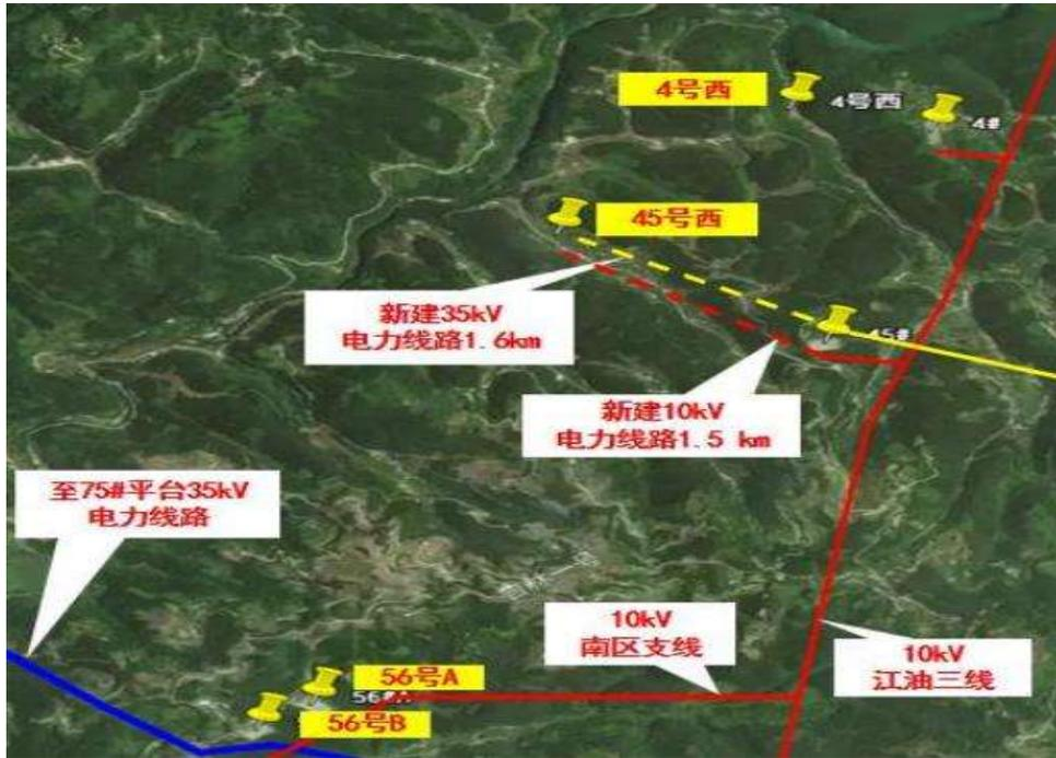
图 2.6-3 45 号西扩平台附近电力线路走向示意图
