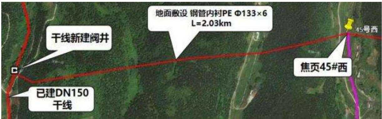
图2.5-5 焦页 45 号西-干线新建阀井管线走向平面图
