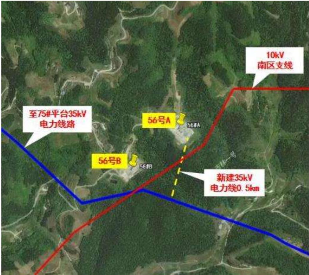
图2.6-5 56号B扩平台35kV架空线路示意图
