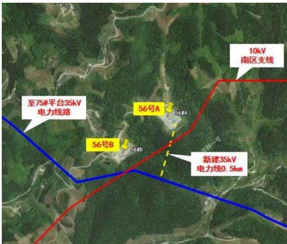
图 2.6-2 56 号 B 扩平台附近电力线路走向示意图
