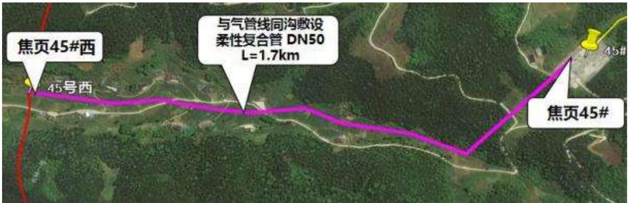
图2.5-3 焦页45号-焦页45号西管线走向平面图
